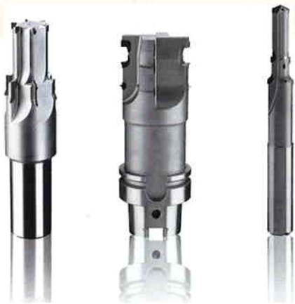
PKD (Polykristalliner Diamant)-Werkzeuge, die am Standort von Rübzig in Nabburg gefertigt werden.
