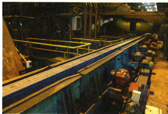
Bild 1. Förder-einrichtung zum Hubbalkenofen; in solch einem Spezialofen werden die Brammen oder Stahlknüppel auf 1.250 °C erhitzt (Fotos: Ceratizit).
