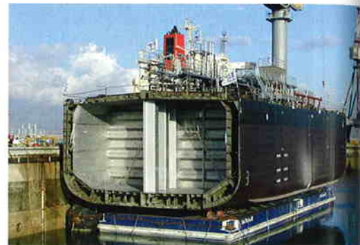
Innenverkleidung aus rostfreiem Stahl in einem Tanker für den Transport von chemischen Stoffen
