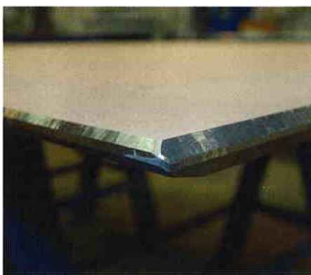
Fertig bearbeitetes Fugenprofil
