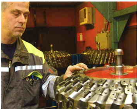
Ein Outokumpu-Mitarbeiter prüft die Fräswerkzeuge
