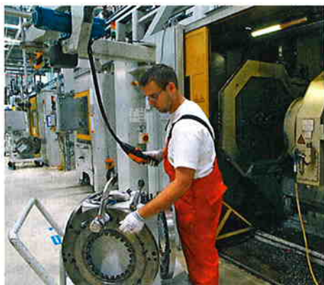
Audi Mitarbeiter beim Ausbauen eines Wirbelfräasers. Nach etwa 250 Kurbelwellen müssen in dem Fräser die Wendeschneidplatten gewendet werden
