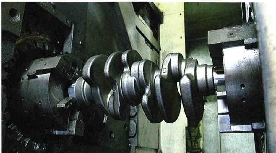
Vor dem Fräsen wiegt eine Kurbelwelle für den 3.0 TDI Motor 26 Kilo, nach der Bearbeitung bringt sie immer noch ganze 18 Kilo auf die Waage
