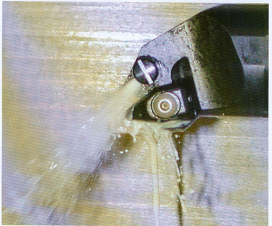
Intelligent positionierte Kühlmittelaustrittsöffnungen für höchste Effizienz.
