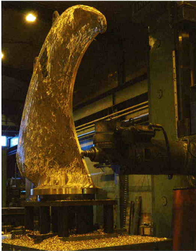
Bei einem Schaufelgewicht von 3,8 Tonnen liegt die Toleranz zwischen den Schaufeln bei nur sechs Kilogramm.
