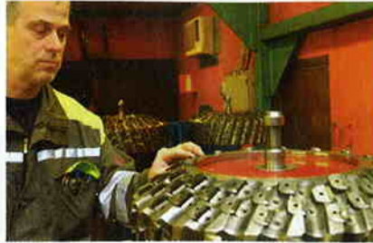
Zähne zeigen: Wendeschneidplatten von Ceratizit lassen sich von rostfreiem Stahl nicht ärgern
