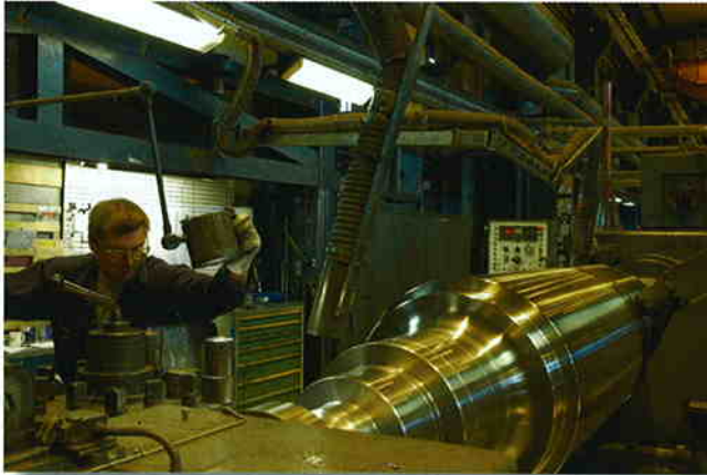
Bild 1: Volle Konzentration ist beim Kopierdrehen gefordert. Eine noch so kleine Unachtsamkeit und die 60 Tonnen-Walze ist Schrott
