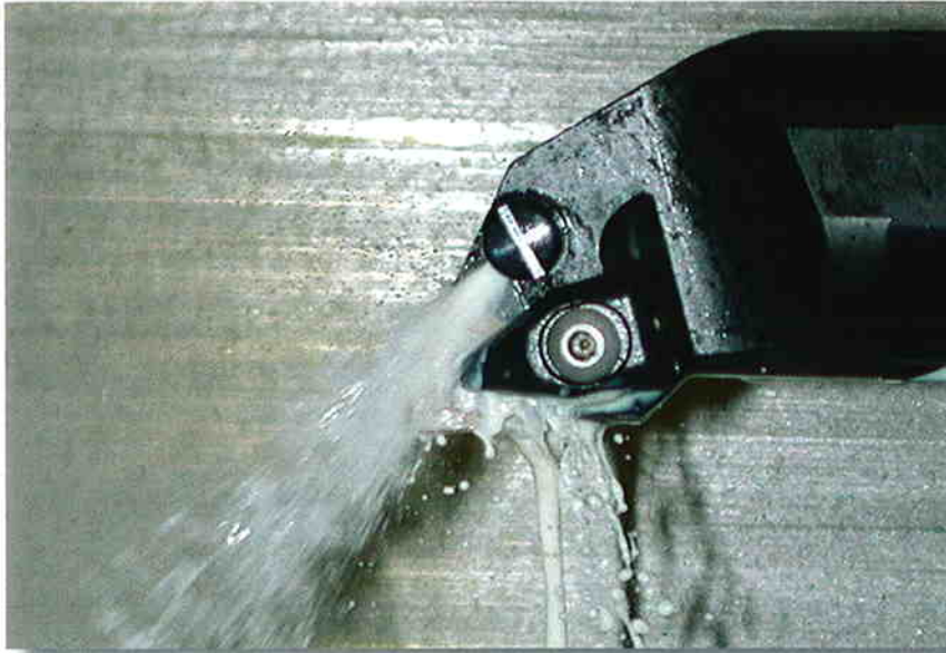
Bild 2: Optimal positionierte Kühlmittelaustrittsöffnungen für hohe Effizienz
