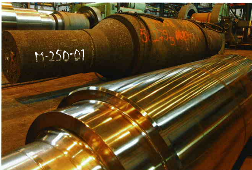
Bild 3: Bis zu sechzig Tonnen schwere Walzen von Åkers
