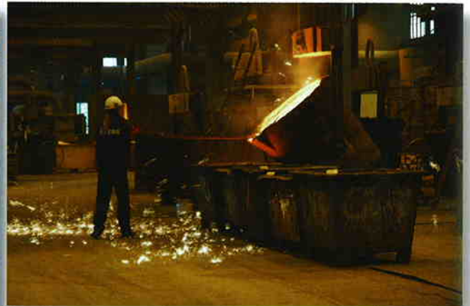
Bild 2: Eine Mitarbeiterin von Åkers prüft die Temperatur der Eisenschmelze vor dem Abgießen
