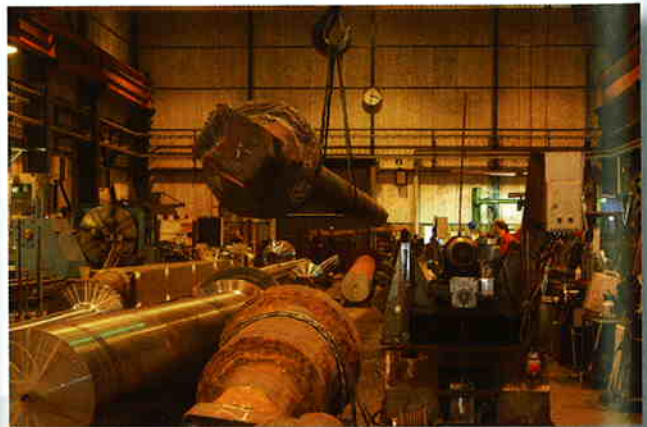
Bild 2: Die Grobzerspannung einer Propellerwelle dauert zwischen 15 und 30 Stunden
