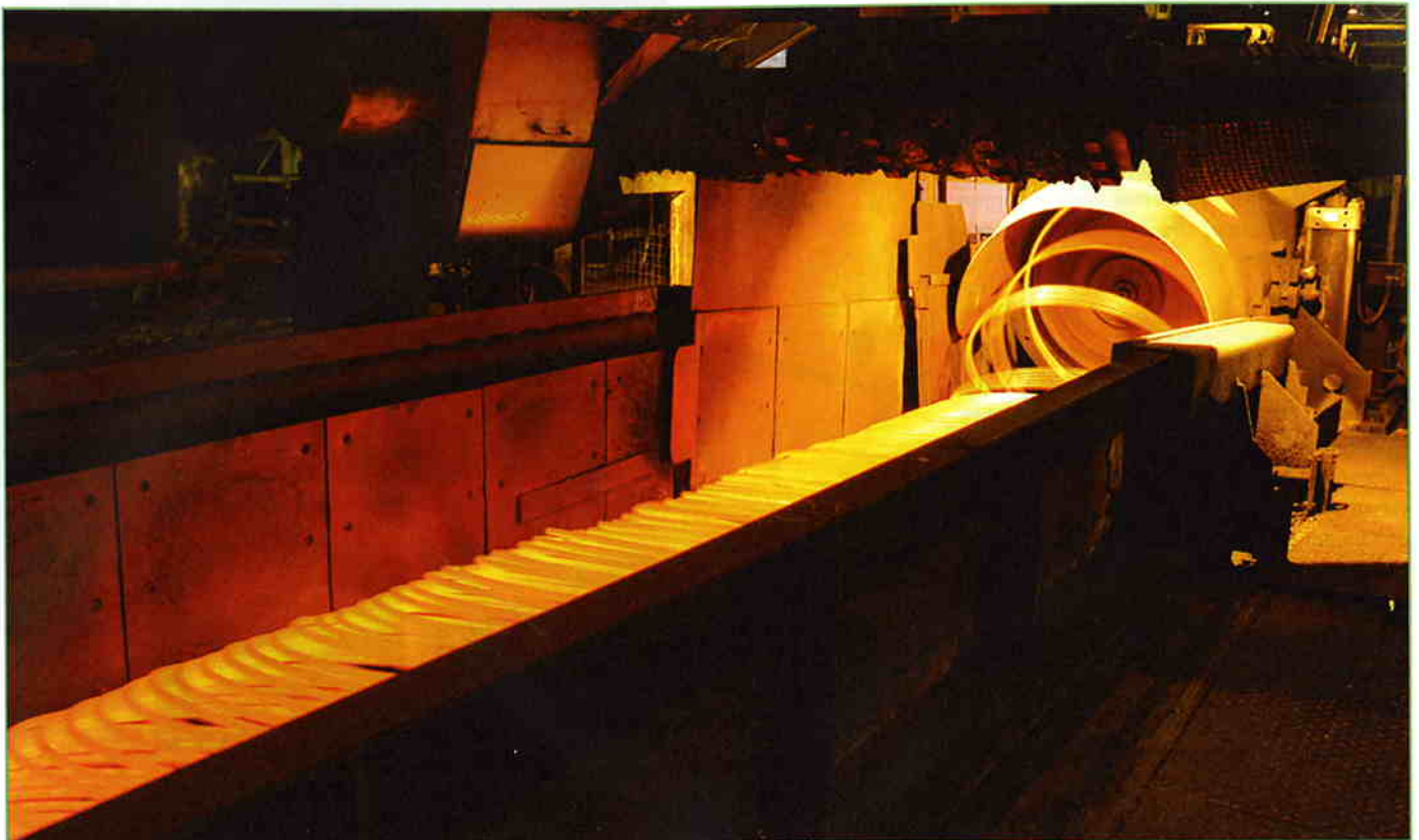
Der noch glühende Draht verlässt die Walzanlage. Bilder: Ceratizit S.A.
