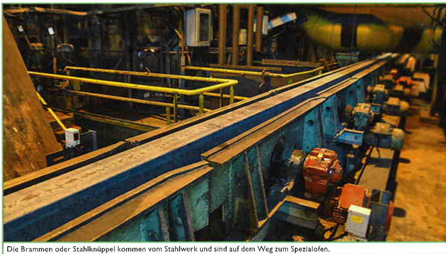
Die Brammen oder Stahlknüppel kommen vom Stahlwerk und sind auf dem Weg zum Spezialofen.
